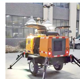
移动照明平台
